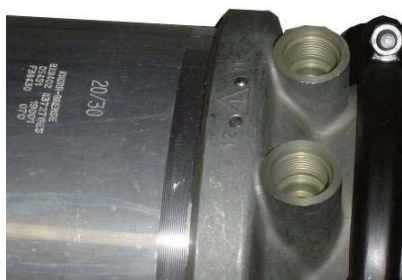
Connection M22 x 1,5 + Voss + Adaptors M16 x 1,5
